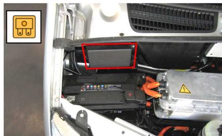
2. Dargestellte Sicherung im Kastendeckel entfernen.
